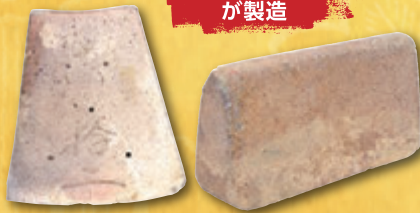
反射炉で使用した耐火レンガ (尚古集成館蔵)
