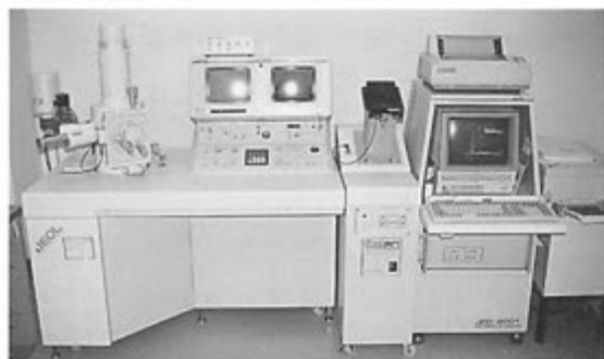
写真1 走査型電子顕微鏡とX線分析装置
