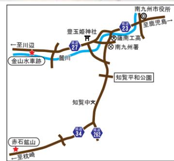
金山水車跡は、明治末期から昭和初期にかけて操業していた製錬所の跡です。直線距離で約8km離れた赤石鉱山から、荷馬車で運んだ鉱石を水車の動力を利用して細かく砕き、金や銀を取り出す作業(製錬)を行っていました。
