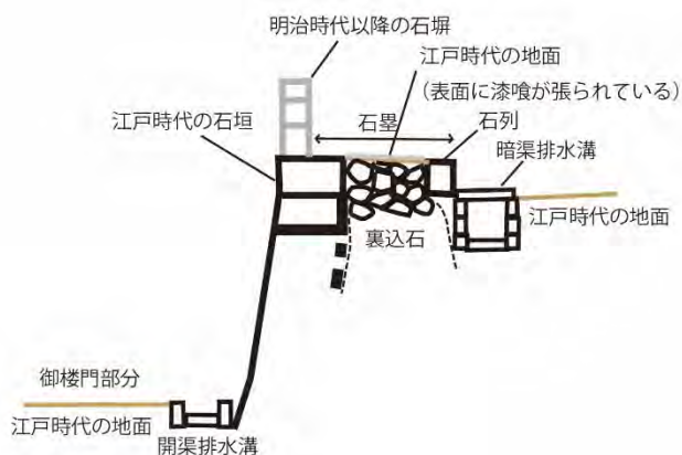
図3 石垣裏側と前面の構造
