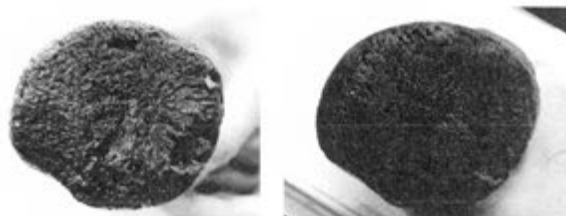
写真 2 資料 No_E14-45-1-2 の木口面 (処理前: 左, 処理後: 右)
