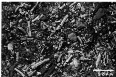
試料5のSEM像 古墳時代土器に付着したベンガラの パイプ状粒子
