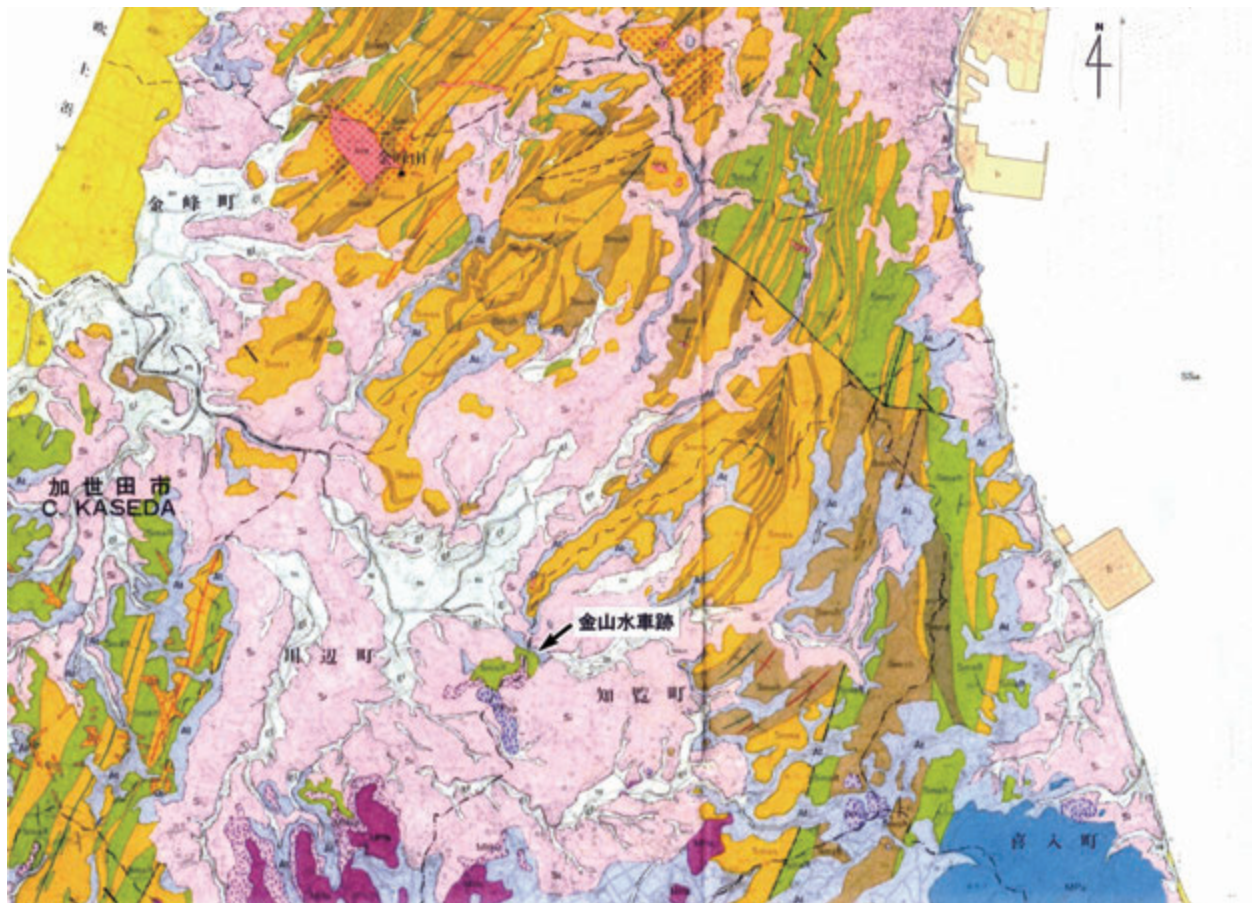
図1 南薩地域の地質（緑・橙：四万十累層群；赤紫・毛羽：青：南薩層群・火山岩類；薄紫 At：阿多火砕流堆積物；桃 Si：入戸火砕流堆積物；鹿児島県地質図編集委員会、1990）
