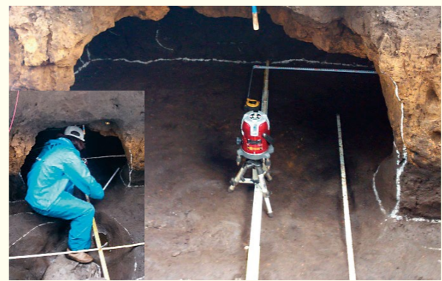
（株）埋蔵文化財サポートシステムによる地下式横穴墓実測の様子。レーザーを利用して計測します。
