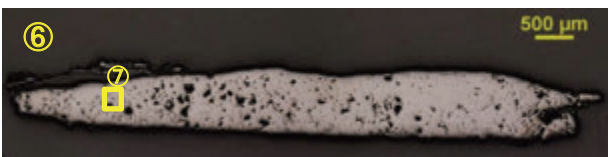
図版 12 製錬滓(ガラス質滓)・鍛冶滓片の顕微鏡写真
