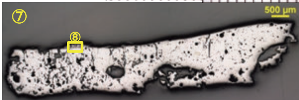
図版 23 製錬滓・鍛冶滓の顕微鏡写真
